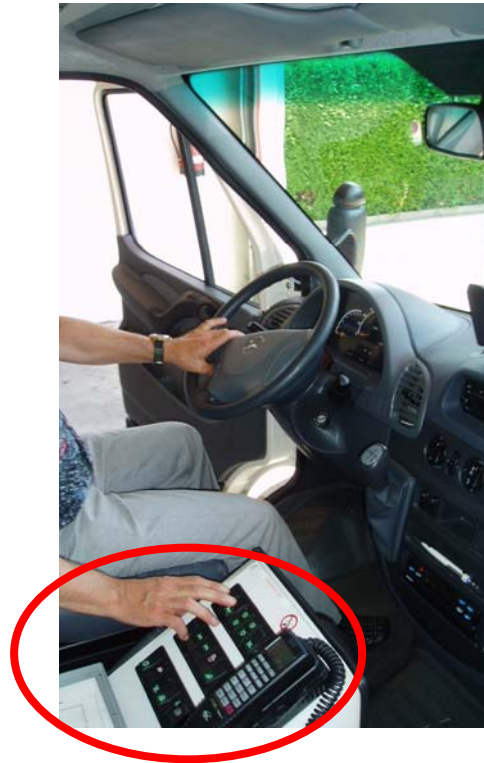
Bedienung Funk und Signalanlage im Blindflug
